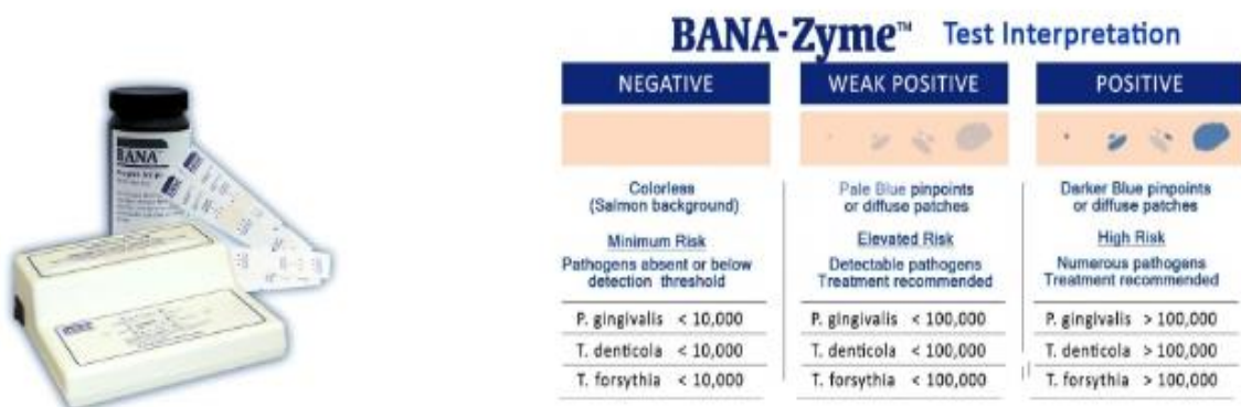
Сл. 1 BANA апарат и стрип-ленти и табеларен приказ за толкување на резултатите
