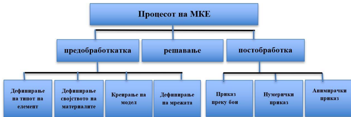
Дијаграм 1. Претставување на фазите на методот на конечни елементи.
