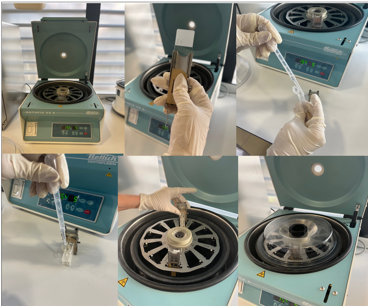
Слика 5: Поставување на примерокот во цитоспин центрифуга
