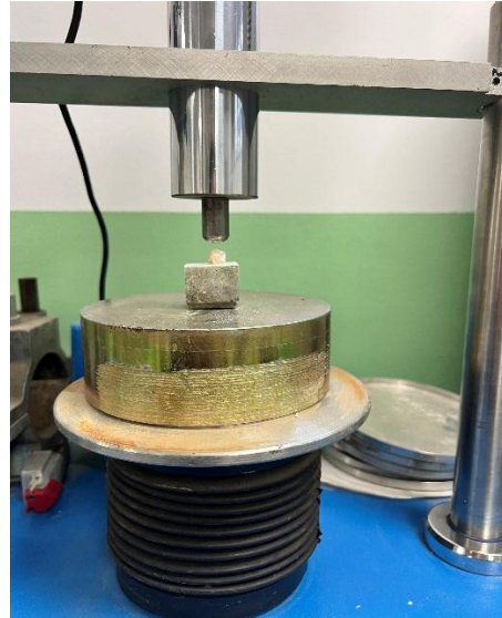
Слика 4: Заб поставен во универзална тест машина
