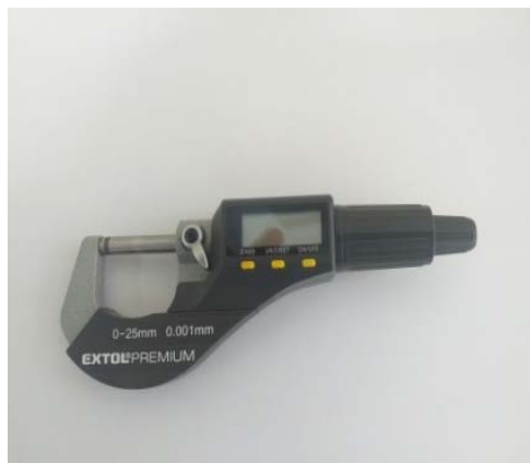
Слика 11. Extoll Premium – Digital Micrometer Caliper
