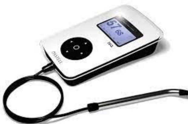
Слика 4: Апарат за мерење на примарната и секундарната стабилност на имплантите Osstell Mentor
