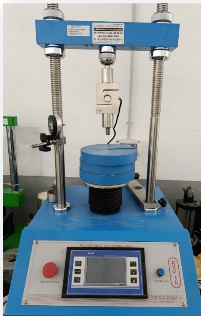
Слика 14: Универзална тестирачка машина full automatic CBR testing Profi x6 Plus
