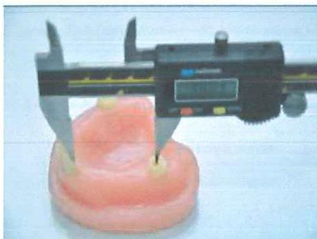
Слика 3. Мерење на хоризонтално растојање
