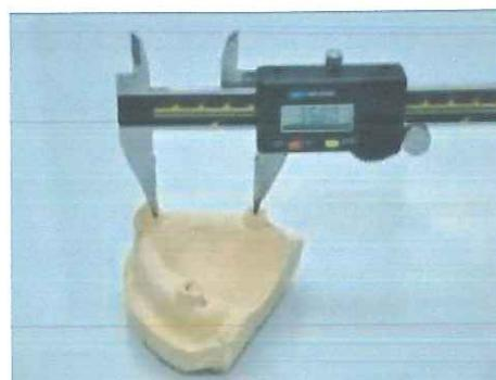
*Слика 20. Мерење на хоризонталното растојание DB*
