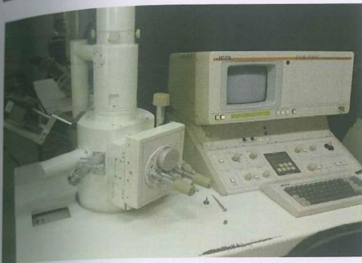
Слика 7. Скен-електронски микроскоп JEOL JSM-5300 Ова испитување го вршевме во Научно-истражувачкиот центар при Стоматолошкиот Факултет во Ниш - Р. Србија
