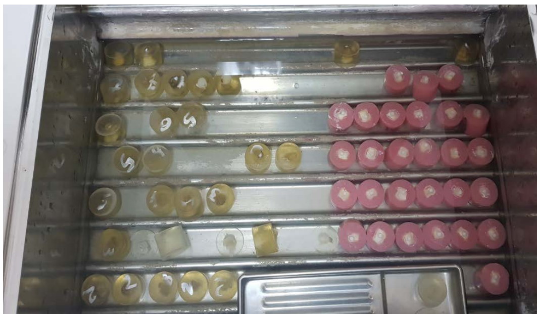
Слика 26 Чување на примероците во водена бања на 37 степени
