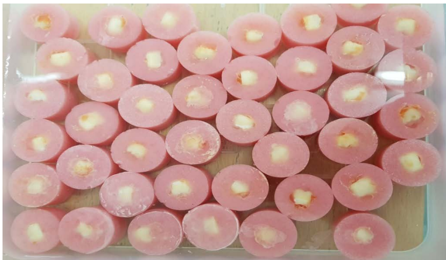
Слика 5 Чување на примероците во сад со вода (ISO 3696, степен 3)
