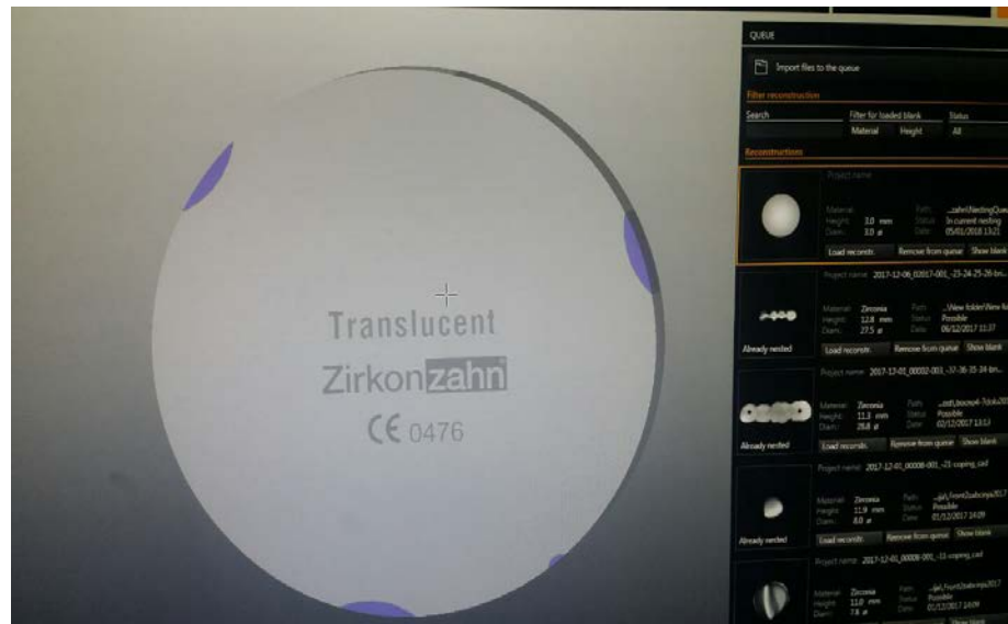
Слика 18 Циркониумски диск, вчитан за режење
