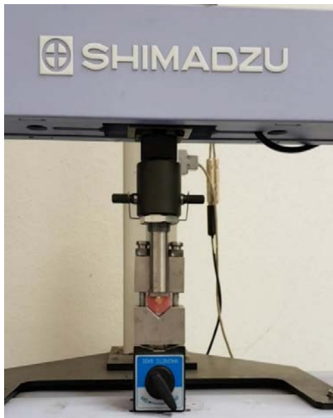
Слика 31 Поставен примерок за SBS-тестирање со назабен ударен клип
