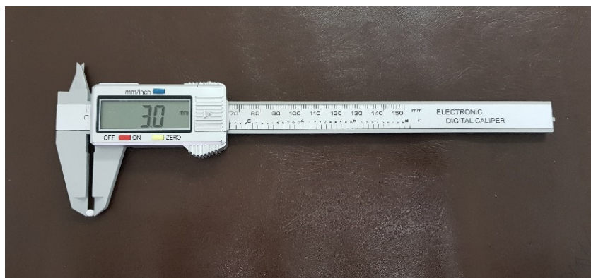
Слика 22 Проверка на дијаметарот со дигитален шублер
