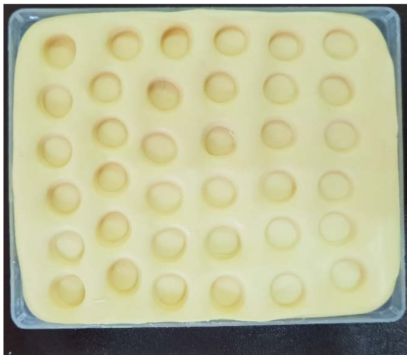
Слика 13 Калап за изработка на акрилатните дискови
