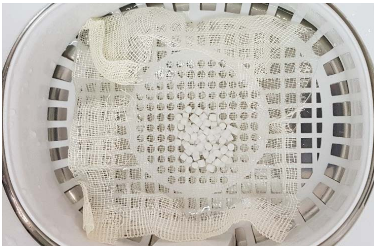
Слика 21 Чистење на циркониумските дискови во ултразвучна бања
