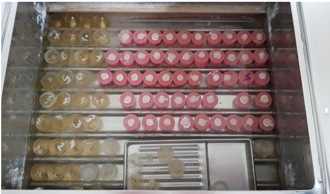
Слика14 Чување на примероците во водена бања на 37° C
