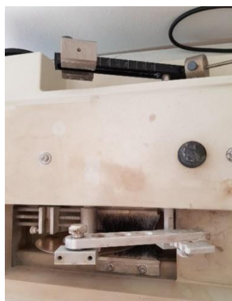
Слика 11 сечењето на примерокот со машина ISOMET 1000
