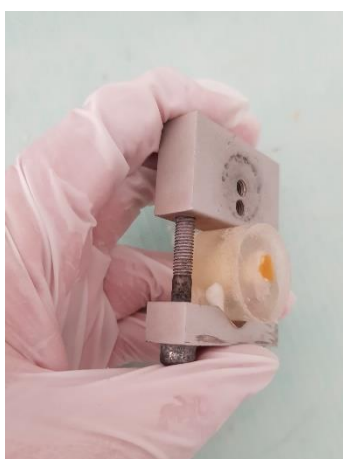
Слика 7 вложените примероци извадени од пластичните калапи
