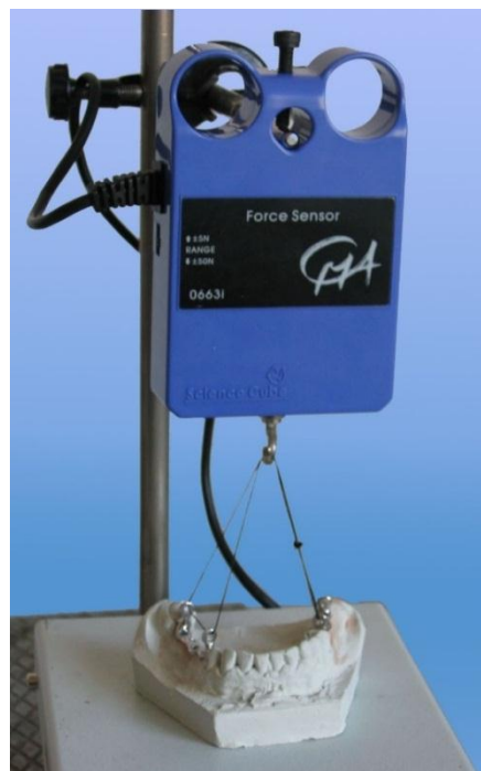
Слика 82. Поставка за мерење на ретенционата сила
