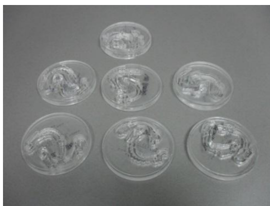
Слика 81. РММА блокови во кои се изрежани скелетите на CAD/CAM ПСП
