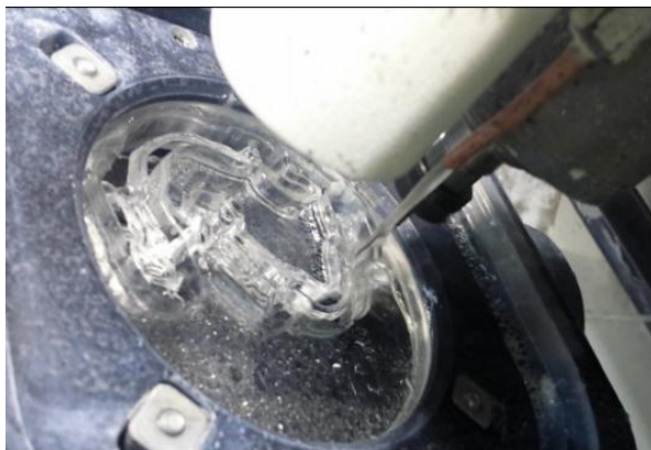
Слика 80. Глодање на РММА блок
