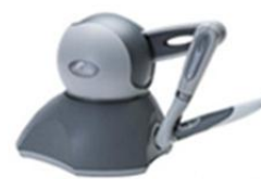
Слика 43. The PHANTOM® Omni ги вклучува фантом уредот и алатка за управување
