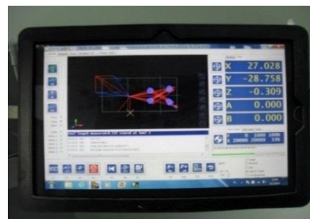
Слика 79. Процесот на глодањето е диригиран од зададените координати x, y , и z
