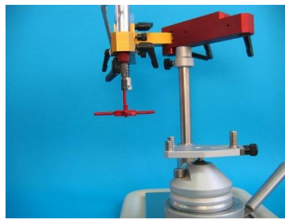
Слика 59. Носечка оска фиксирана во паралелометар
