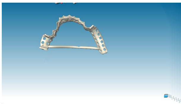
Слика 78. Подготвен скелет за CNC обработка
