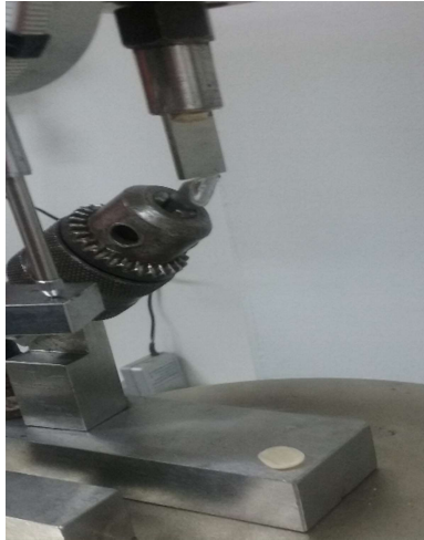
Слика 22. Притисок на експерименталниот примерок до појава на оштетување
