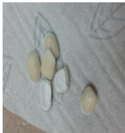
Слика 17. Пескарење со \text{Al}_2\text{O}_3
