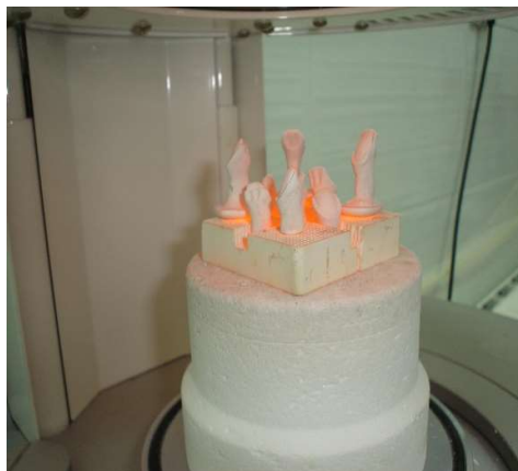
Слика 8. Синтерување на огноотпорните трупчиња
