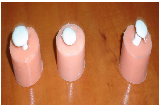
Слика 6. Силиконски калапи за добивање на огноотпорни трупчиња
