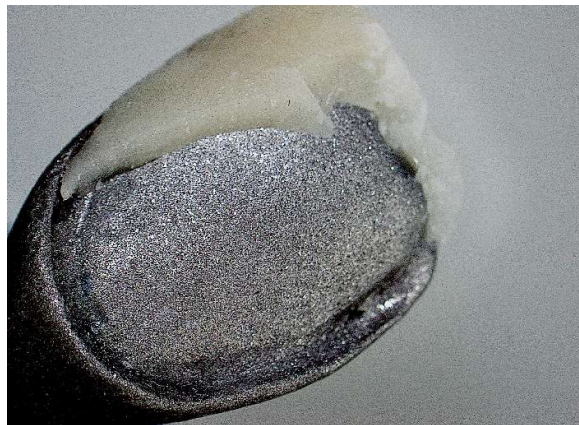
Слика 28. Фрактура на фасета со комбинирана локализација
