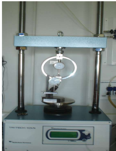
Слика 20. Триаксијална тестирачка машина TRITECH WF 10056.
