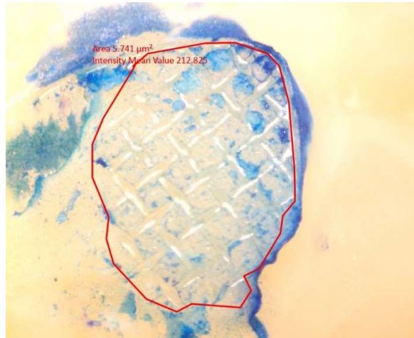
Слика 8 - Мерење на површината на атхезивен остаток на забот во \mu\text{m}^2 кој останал после дебондирање на металната брекета со помош на микроскоп- Apochromatic Stereo Microscope ZEISS Stemi 508
