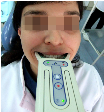
Слика 25. Приказ на поставеност на сензорот помеѓу централните инцизиви, паралелно со оклузалната рамнина, центрирајќи ја одбележаната средина на рачниот конвертор на податоци со средината на горниот забен низ.
