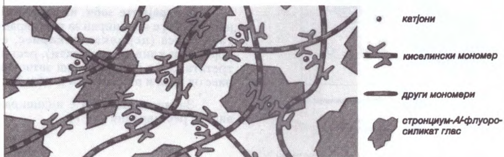
Слика 3. Комјомерите обединуваат две функционални групи на композициите (C=C) и на глас јономер цементите (карбоксилни групи на поликарбоксилната киселина) во еден молекул
