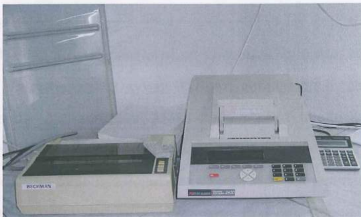
Сл. 3 Perkin- Elmer GeneAmp PCR System 2400 термосјклер
