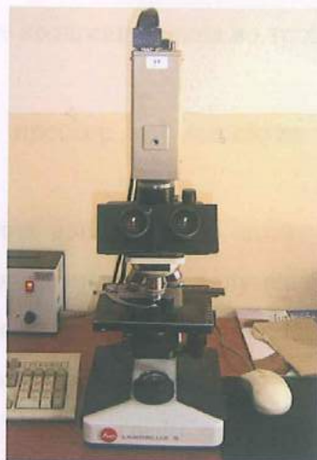
Сл. 15. Светлосен микроскоп Leitz – Laborlux – S со вградена камера
