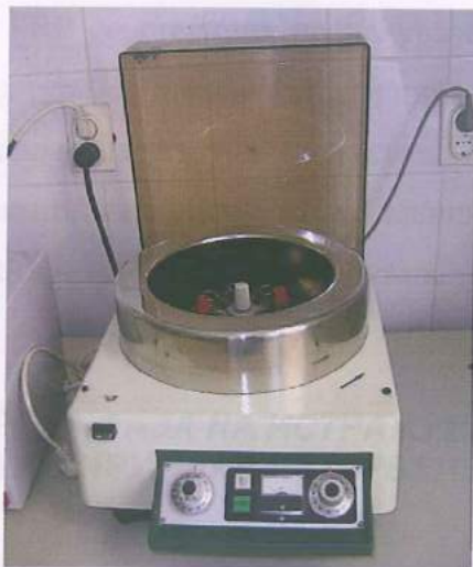
Сл.8 Апарат за центрифугирање HETTICH UNIVERSAL ZENTRIFUGEN
