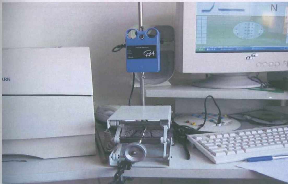
Слика 2. Динамометар за мерење на силата на ретенцијата, со уреди што го следат (интерфејс, компјутер)
