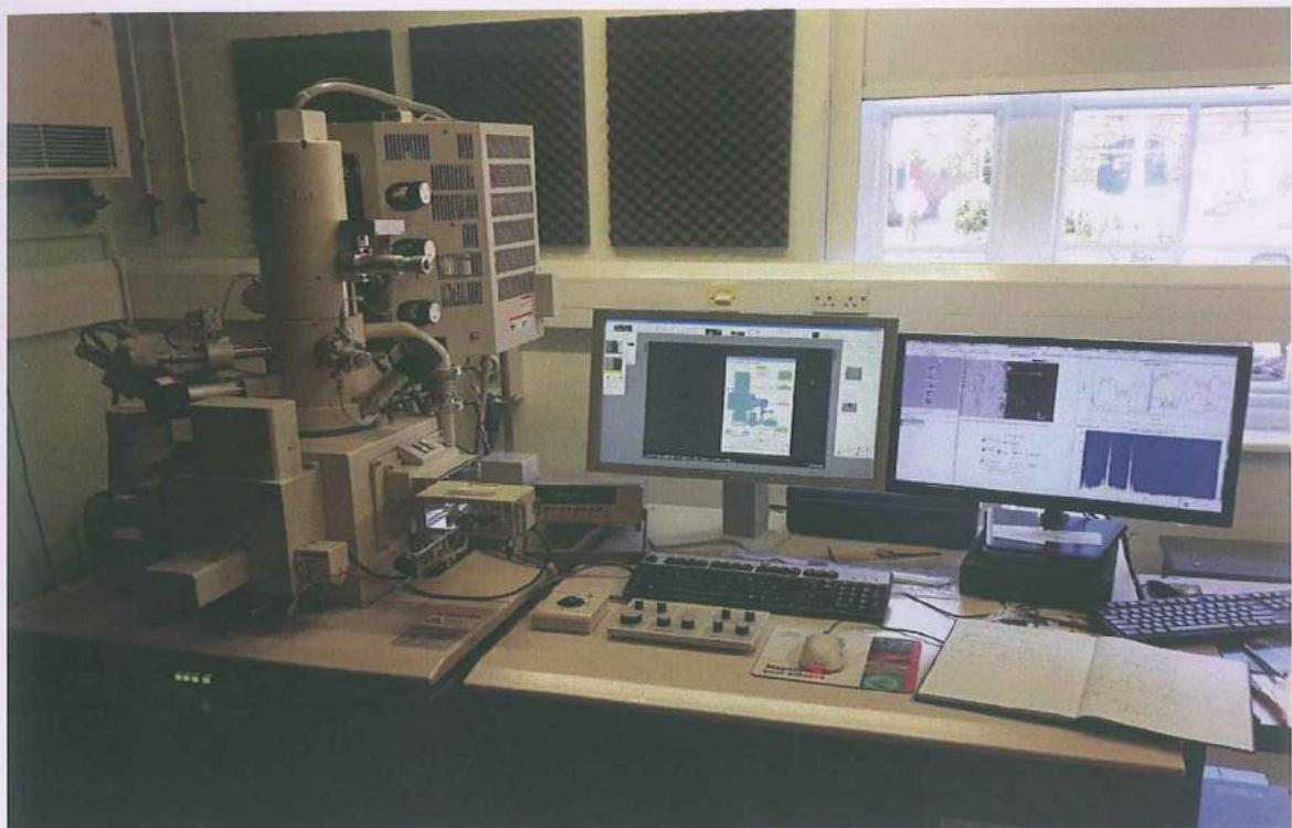
Слика 5. Скенинг Електронски Микроскоп - Field-emission gun scanning electron microscope (FEG-SEM Hitachi SU 8030, Japan).
