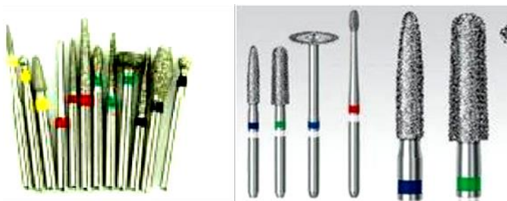
Слика 96. Дијамантски борери за обработка со различна финост на абразивните честички.
