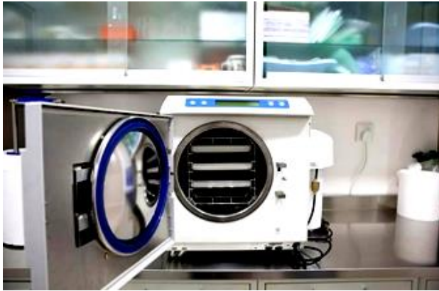
Слика 139. Автоклав апарат за стерилизација на инструменти во денгални ординации.
