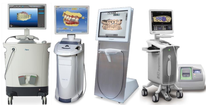
Слика 61. Апаратура за CAD/CAM технологија со која се врши интраорално скенирање и дизајн на надоместоците.
