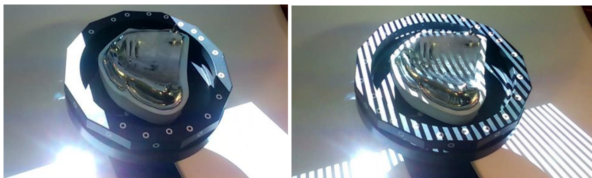
Слика 4: Скенирање мастер-модел: а) поставување гипсен модел со метална база на подлогата на скенерот; б) постапка на скенирање.
