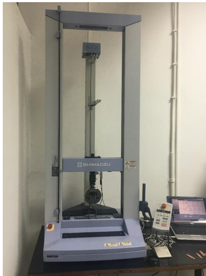
Слика 24: Универзална тестирачка машина (Schimadzu AGS-X)
