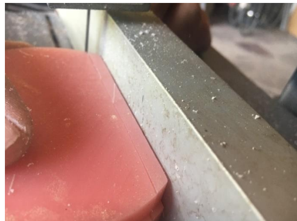
Слика 19: Припрема на акрилатен примерок од CAD/CAM-група: а) индустриска тракаста тестера и б) сечење CAD/CAM акрилатен блок
