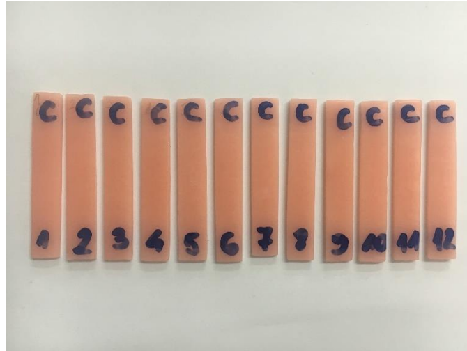
Слика 21: Група од 12 акрилатни примероци, припремена за испитување отпорност на свиткување
