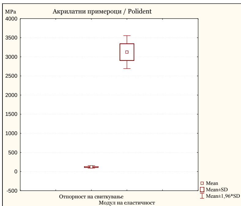
Графикон 23: Акрилатни примероци изработени со CAD/CAM-технологија/Polident
