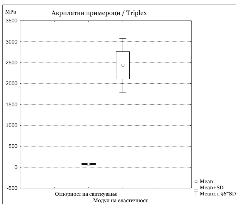
Графикон 21: Акрилатни примероци изработени со конвенционална техника со топлополимеризиран акрилат/Triplex
