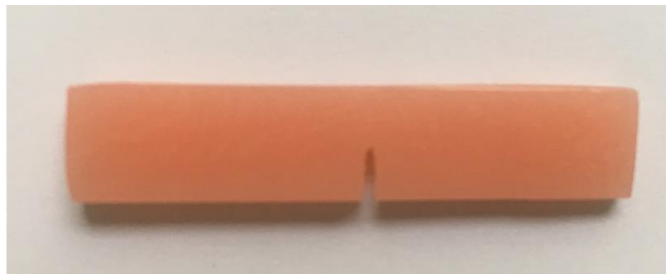
Слика 22: Акрилатен примерок за испитување отпорност на кршење
