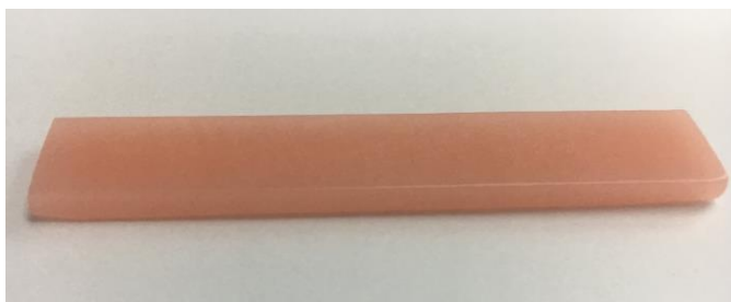
Слика 20: Акрилатен примерок за испитување отпорност на свиткување
