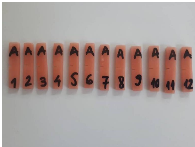
Слика 23: Група од 12 акрилатни примероци, припремена за испитување отпорност на кршење
